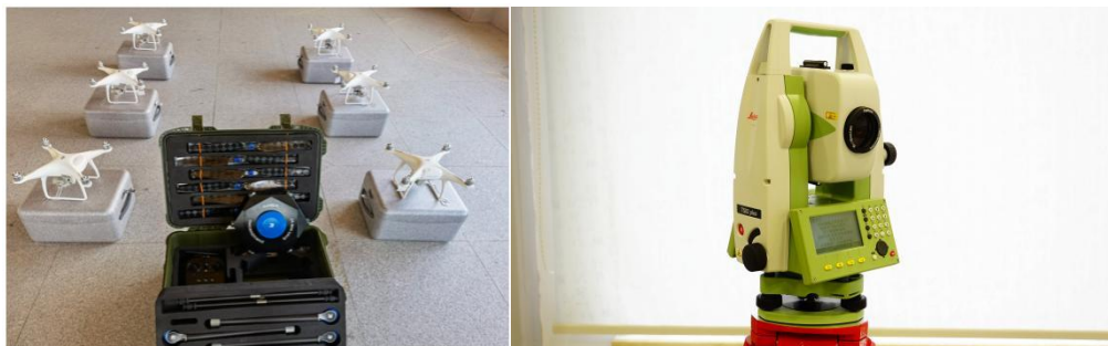
图2 实训设备（左为无人机，右为测量机器人）
